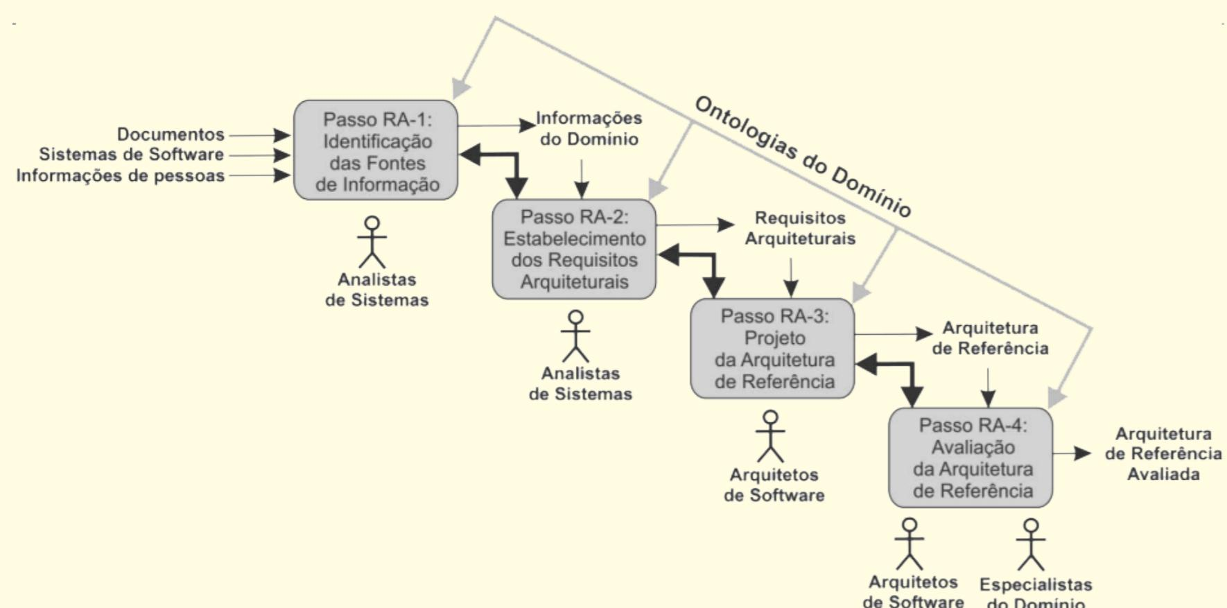
Figura 1: Estrutura do processo ProSA-RA
